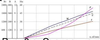
Рис. 6.2. Экспериментальные данные электрогенератора и ветроротора.
